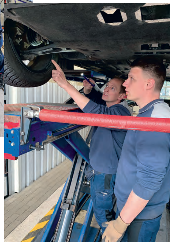
Prüferingenieur Gordon Ehrens (rechts) und Stationsleiter Pascal Raisin (links) schauen gemeinsam nach der Manschette für die Antriebswelle des rechten Vorderrads
