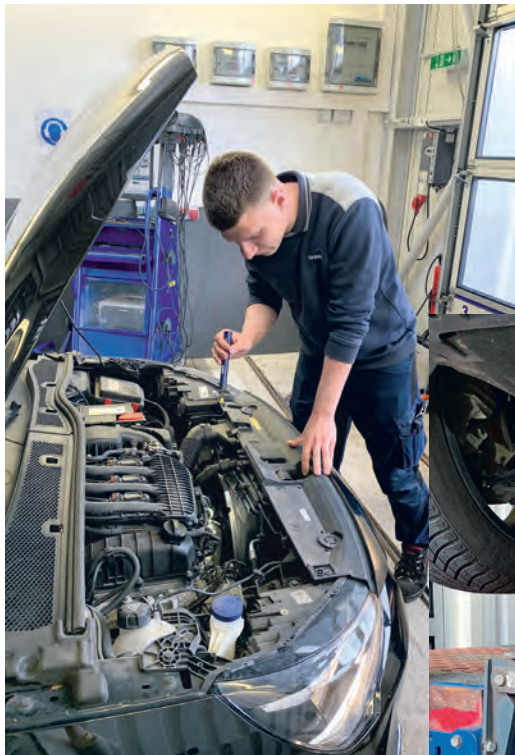
Prüferingenieur Gordon Ehrens schaut nach Undichtigkeiten am Motor und nach defekten Schläuchen/ bzw. Leitungen
